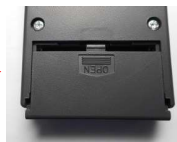
図 3-2 電池カバー取り外し
