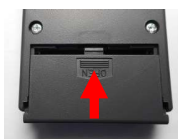
図 3-4 電池カバー取り付け
